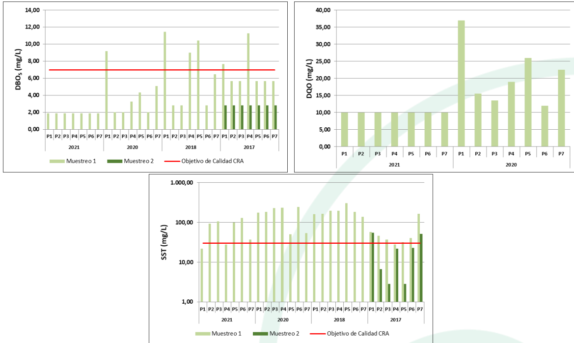
Figura 48. Variación de la DBO 5 , DQO y Sólidos Suspendedos Totales (SST) en la Ciénaga de Mallorquín en el monitoreo realizado en-noviembre de 2021, en comparación con monitoreos anteriores y los objetivos de calidad.
